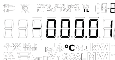
Рис. 2 – Установка отрицательного TL2 в меню НАСТРОЙКИ, - будет мигать при нахождении курсора на этой позиции, он останется при переходе на другой знак.
